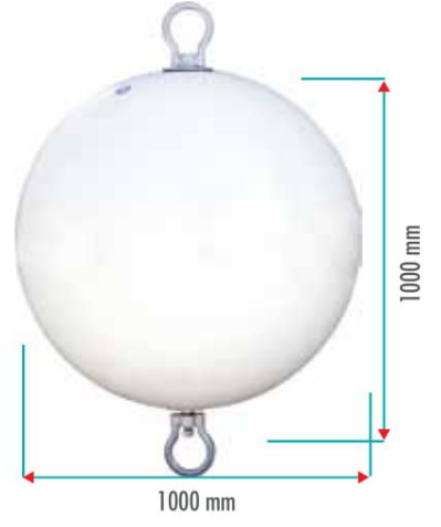
M03303 500 LT ŞAMANDIRA / BUOY Yüzdürmesi / Buoyancy: 450 kg Ürün Ağırlığı / Weight: 38 kg
